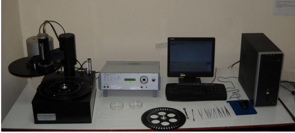
Şekil 5.5. Risø TL/OSL Sistem Model DA-20 ölçüm sisteminin genel görünümü.
