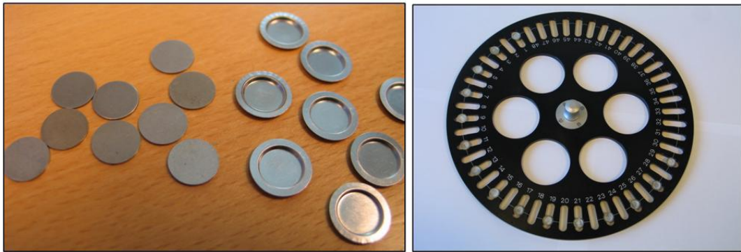
Şekil 5.7. 48 örnek haznesine sahip örnek tablası ve örneklerin yerleştirildiği diskler (DTU TL Okuyucu Kullanım Kılavuzu, 2013).
