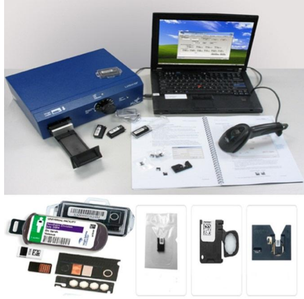
Şekil 2.10. microStar OSLD okuyucu, nanoDot ve Inlight dozimetreler (IX; X).
