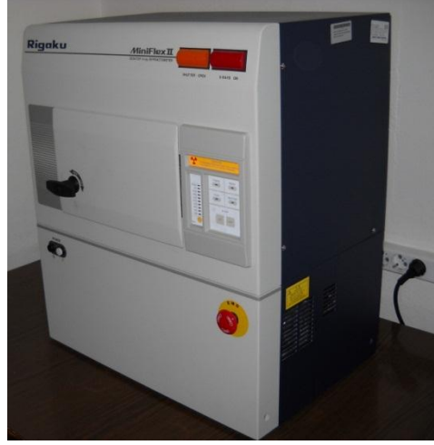
Şekil 5.15. Rigaku Miniflex II XRD ölçüm sistemi.
