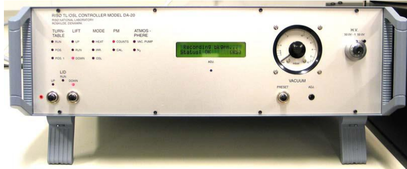
Şekil 5.14. Bir Windows komut programı tarafından yönetilen kontrolör.
