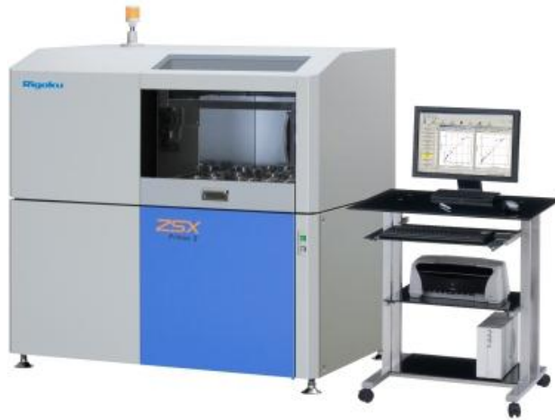
Şekil 5.16. Rigaku marka ZSX Primus II model dalga boyu dağılımlı X-Işını floresans spektrometresi cihazı (XVIII).
