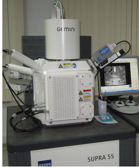
Şekil 5.17. FE-SEM ölçüm sistemi.
