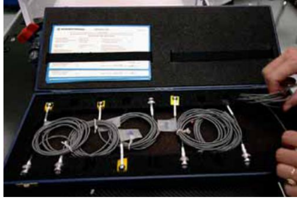
Şekil 2.6. Yarı iletken dozimetri sistemi (VII).
