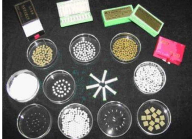
Şekil 2.7. Değişik şekil ve biçimlerde termolüminesans dozimetreler (VIII).
