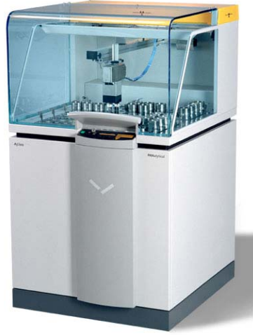
Şekil 4.14. Panalytical Axios Advanced model dalga boyu dağılımlı X-Işını Floresans Spektrometresi cihazı.
